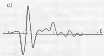
Рис. 17. Характеристики взрывного источника звука: а — гидроакустический сигнал; б — его спектр.
